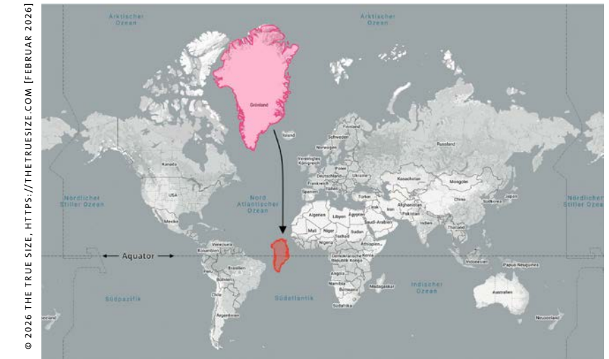
Vergleich der Größe von Grönland in der Mercator-Projektion (pink) und in tatsächlicher Größe (rot) am Äquator. Ausschnitt von The True Size of ...
